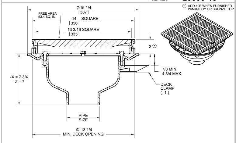
SLOT WIDTH 5/16" ( -50 & -51 SLOT WIDTH 1/4" )
